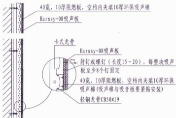
吸声板(基板)墙面安装做法(竖)
